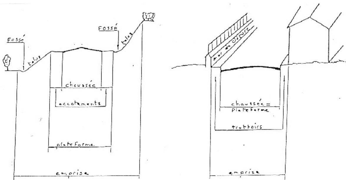
L'emprise d'une voie publique est délimitée par l'alignement. Elle se compose de la plate-forme (partie utilisée pour la circulation et le stationnement des véhicules automobiles) et de ses annexes (accotements, trottoirs, fossés, talus).
